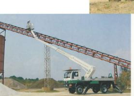
Geländegängige LKW- Hubarbeitsbühne mit Differenzialsperren und Geländeuntersetzung
